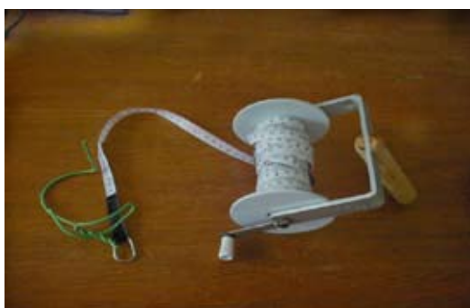
Figura 1- Trena chumbada desenvolvida pela equipe do Reef Check Brasil.
