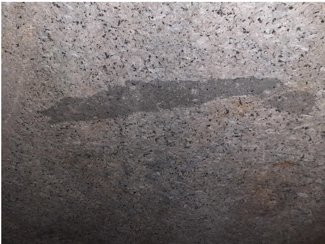
Detalhe de bloco de Nefelina Sienito da foto anterior, mostrando trama homogênea e granulometria grossa da rocha, com enclave de rocha de traquito/fonolito de granulometria fina.
