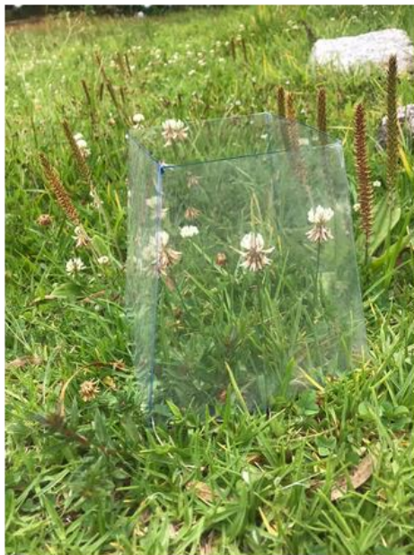
Câmara de acrílico de 15 cm (base) x 15 cm (altura) x 10 cm (topo) posicionada em indivíduos de T. repens .
