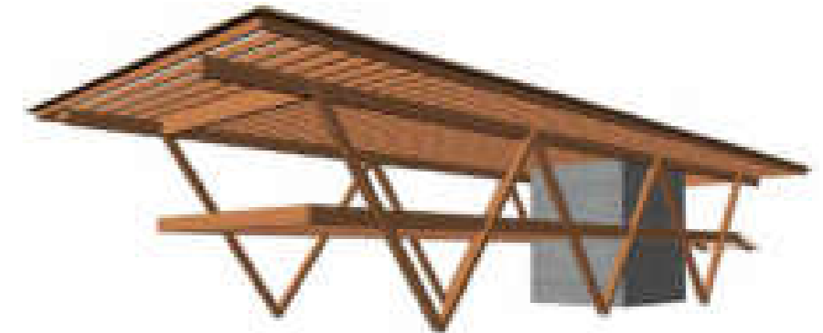
Projeto básico estrutural em madeira laminada colada para fabricação das peças da estrutura. Fonte: ITA Construtora
