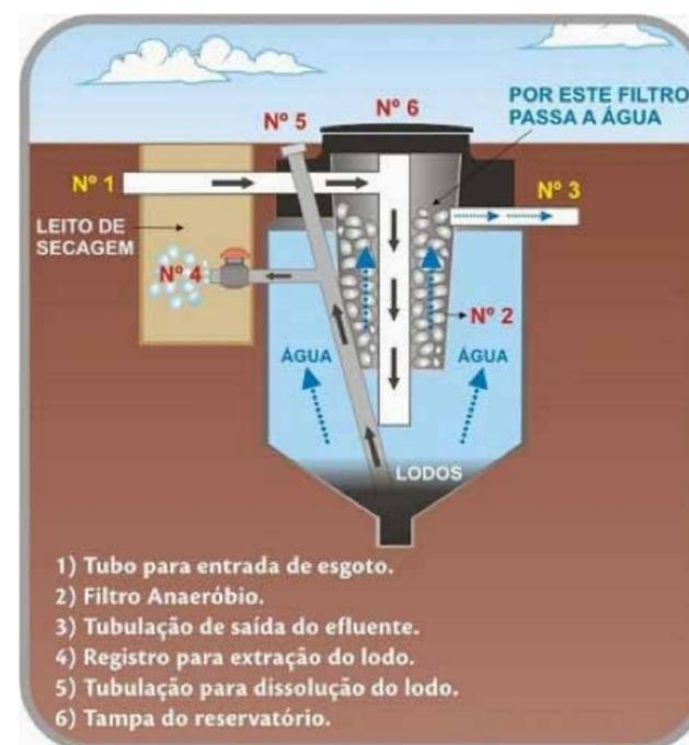
Exemplo de biodigestor
