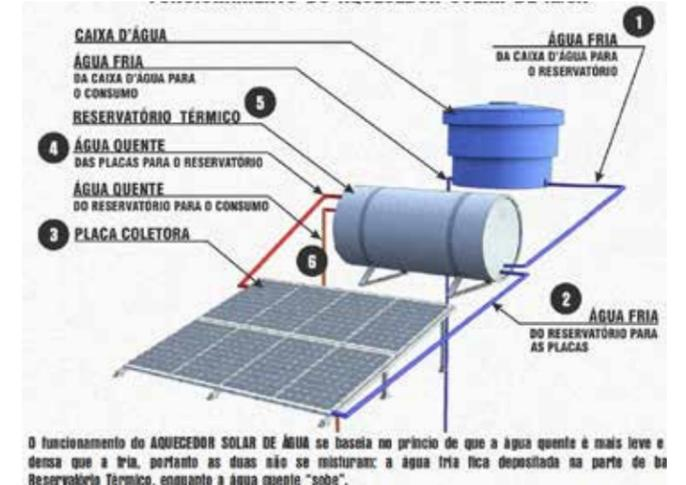
Funcionamento do aquecedor solar de água
