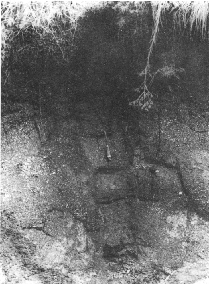
FOTO 7 — Colúvios C III , com espessura de 2,50m e forte contraste de cor entre a matriz escura e os grânulos e pequenos seixos concentrados em diferentes níveis do perfil.
