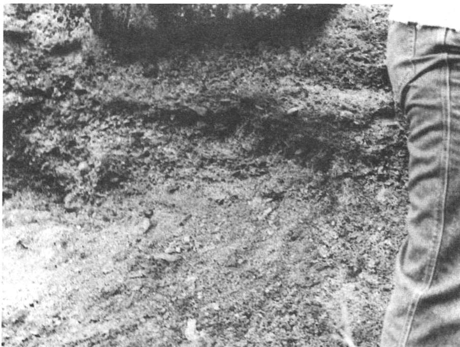
FOTO 8 — Depósito de seixos e blocos, achatados e angulosos, sem matriz, sotoposto aos dois níveis de colúvios.
