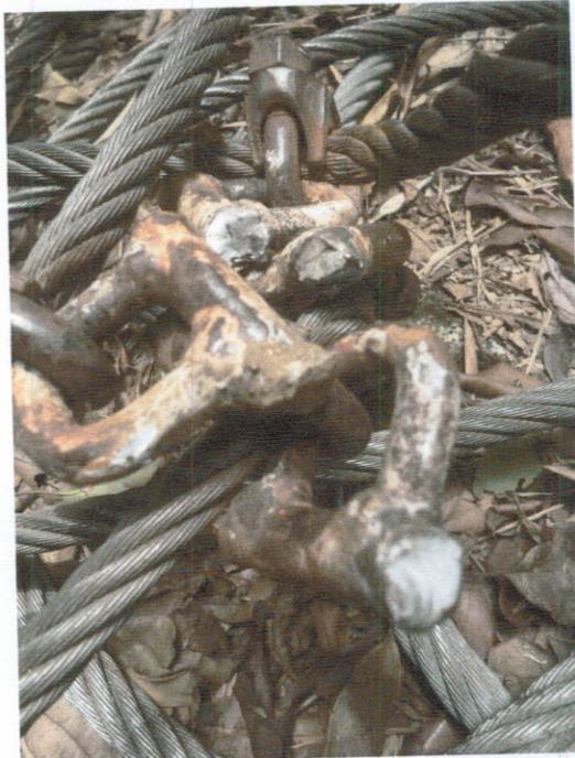
**Figura 1 - Grampos quebrados e deixados na base da via.**
